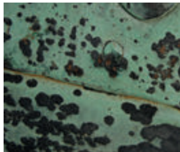
32. Immagine della superficie di una lamina proveniente dalla parte del manufatto raffigurante un leone, che mette in evidenza la presenza delle formazioni tondeggianti di colore grigio scuro.
